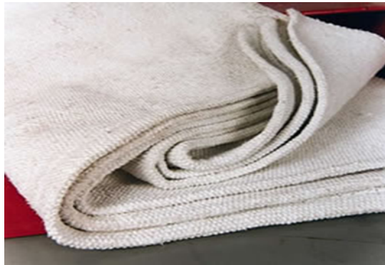
Asbestos fire blanket
